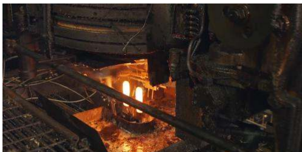
Flüssiges Glas in der Produktionsstraße
